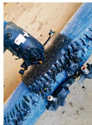
**Die Arbeiten zum Breitbandausbau führten zu diesen Schäden an der Wasserleitung.**
